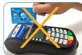
Toda tarjeta con CHIP solo debe leerse en la lectora especial y toda tarjeta SIN CHIP por la lectora de banda.
